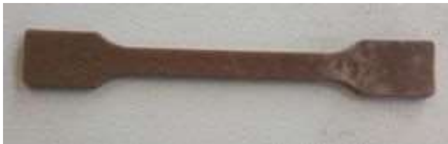
Fig. 12. PLA-TPU-bamboo composite test specimen.
