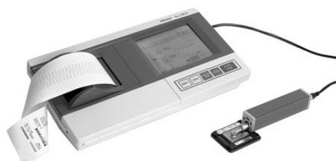
Fig. 1. Surface Roughness Test Device (Mitutoyo 2002)
