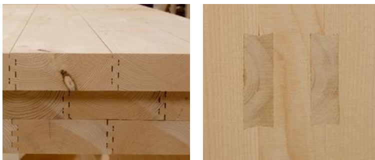
c - Panou reconstituit din lamele de lemn masiv îmbinate cu cepuri tip lambă aplicată / Solid wood panel made of inlaid tongue jointed lamellas (Soligno, Italy).
